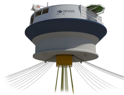
(d) Alternative circular FPSO (SEVAN concept) (Dalane et al. , 2009)
